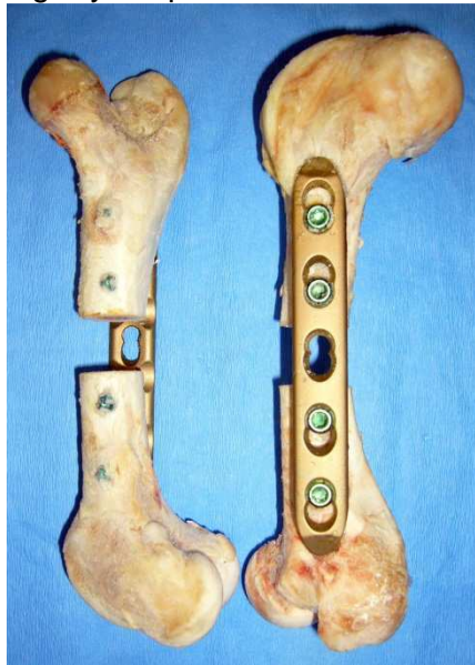
Obrázek 1 – Reálný vzorek systému fixace segmentálního defektu femuru 4,5 mm LCP (bez soustavy uchycení kosti s duracrylem)
